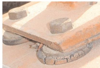
Un esempio di tassello in gomma compromesso nella sua funzione, a causa di un pronunciato degrado dovuto ad invecchiamento
